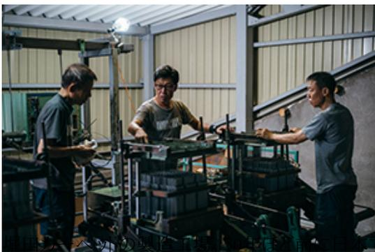
で生産されたウィルトン織機を何度もメンテナンスをしながら大切に使用している
